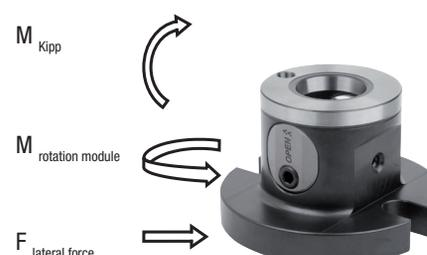
\* Jusqu'à une force transversale de 1.000 N, le fonctionnement correct des modules de bridage, notamment en ce qui concerne la répétabilité, est garanti. Jusqu'à une force transversale critique de 7.000 N, la sécurité en cas de défaillance et la sécurité des personnes sont garanties pour les modules de bridage.
